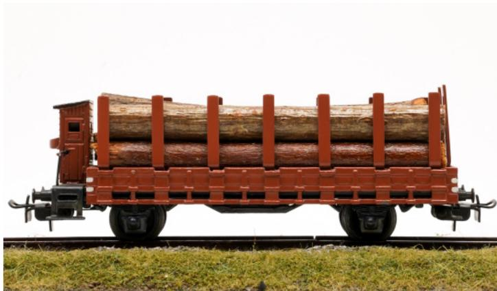
Variante 2 (1950-51) - Bremserhaus am Wagenboden angeschraubt, angesetztes Bühnengeländer rechts und links im Bremserhaus endend, am Bremserhaus angegossene Bremsspindel
