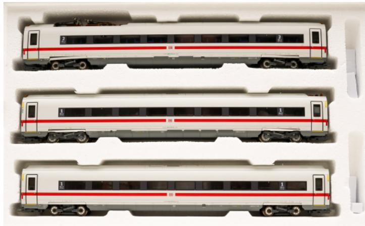
Ergänzungswagen für den Hochgeschwindigkeitszug ICE 4, Baureihe 412/812 der Deutschen Bahn AG (DB AG). 1 Mittelwagen MW 1, Baureihe 812, 1. Klasse. 1 Mittelwagen TW 1.2, Baureihe 412, 1. Klasse. 1 Mittelwagen MW 2.2-HP, Baureihe 812, 2. Klasse
