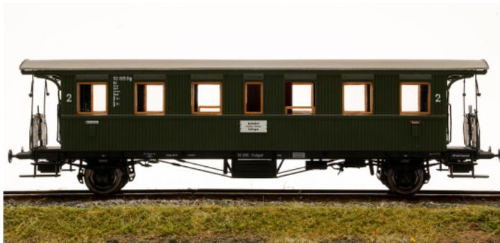
Angesetzte Schilder, Griffstangen und Trittstufen; extra angesetzte Bremsrücksteller aus Ätzblech; mehrteilige Bremsanlage mit Bremsbacken in Radebene.
