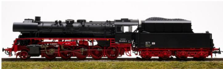
Dampflokomotive Baureihe 50.40 der Deutschen Reichsbahn (DDR)
