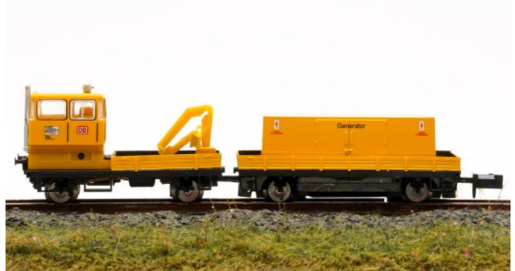
Rottenkraftwagen KLV 53, 2-achsig, mit 2-achsigen Anhänger der DB AG, gelb
