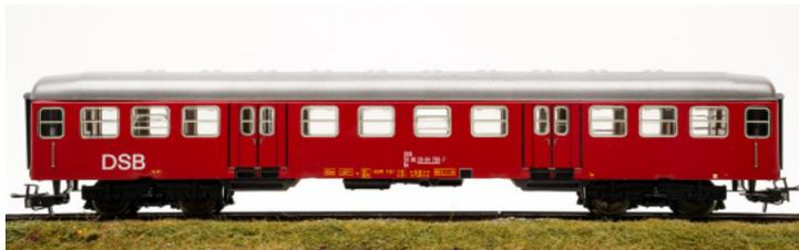
Variante 1: Auf der "Toilettenseite" befindet sich am anderen Wagenende über der angesetzten Griffstange ein zusätzliches Fenster
